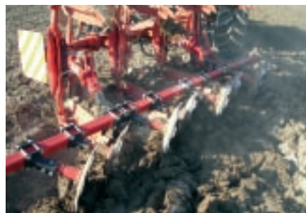
Foto 1. Een snedemixer of -verdeler aan de ploeg egaliseert de ploegsmeden in een en dezelfde werkgang.
